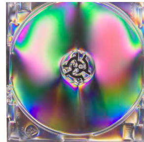
偏光の性質の例： 残留応力の可視化
